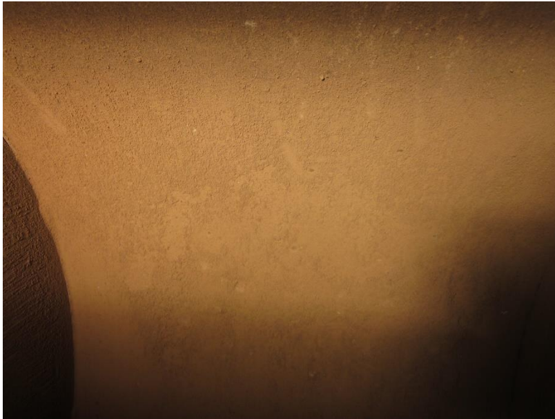
Mynd 4. Efni klesst innan á tromlu eftir prófun á Haukadalsá.
