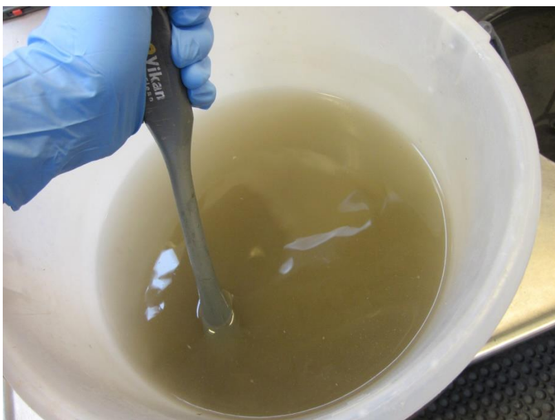
Mynd 2. Hrært í sýni með plastskafti til að losa um loftbólur.
